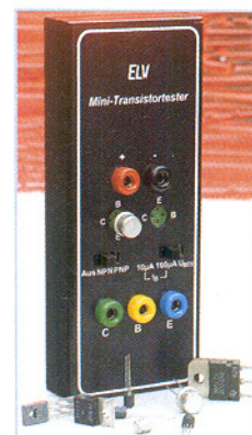
▲ Mini-Transistor-Tester testet den Gleichstrom-Verstärkungsfaktor B Seite 74
