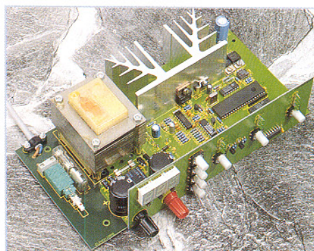
▲ Akku-Lade-Meßgerät ALM 7003 zum vollautomatischen Laden, Entladen, Testen und Regenerieren (Zyklen) von Ni- und NiMH-Akkus und Akkupacks Seite 46
