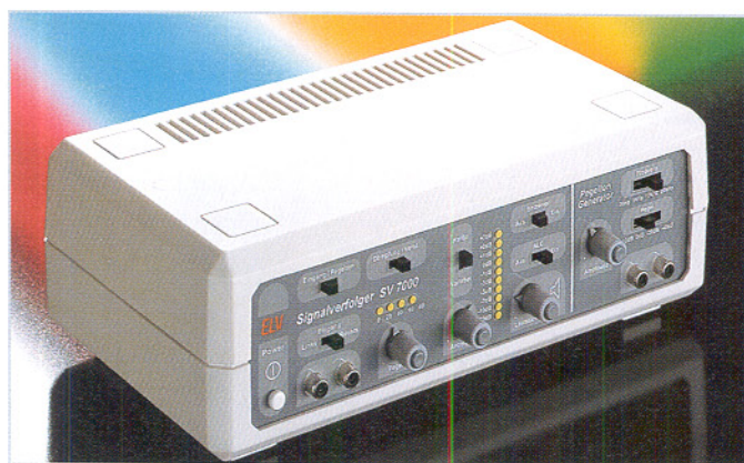
▲ NF-Signalverfolger Vielseitiges Hilfsmittel im Audio-Geräteservice Seite 26
